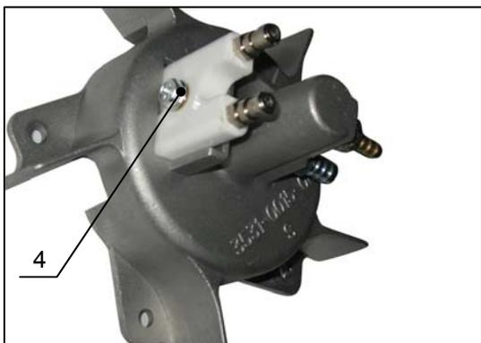
**Рис. 7, Снятие свечи зажигания**
