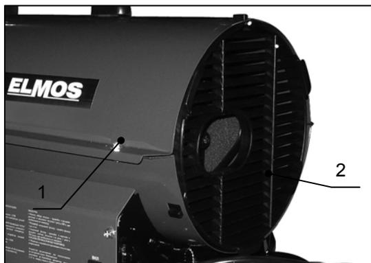
**Рис. 5, Снятие верхней части кожуха**
