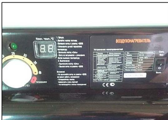
**Рис.3 Термостат/Кнопка ВКЛ/Выкл**
