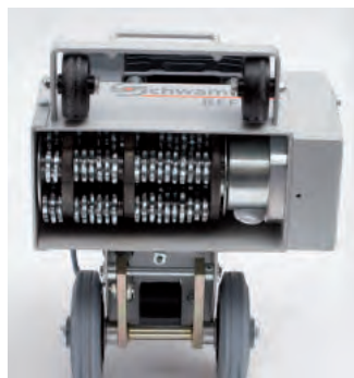
Серийно с возможностью фрезеровать от края
