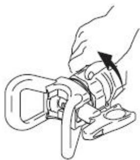
4. Снимите предохранитель наконечника.
