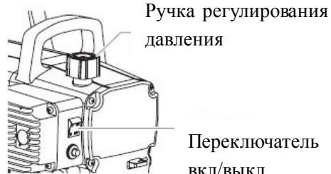
3. Увеличьте давление, чтобы запустить двигатель, и дайте жидкости поциркулировать через сливную трубу 15 секунд, затем выключите давление.
