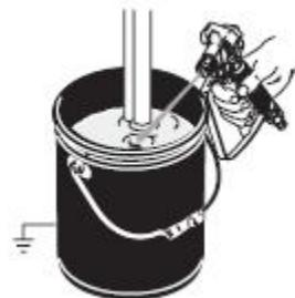
2. Прижмите краскораспылитель к стенке заземленного металлического ведра для промывки. Затем нажмите на спусковой механизм, чтобы сбросить давление
