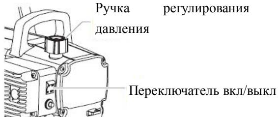
1. Поверните ручку регулирования давления на самое низкое давление.
