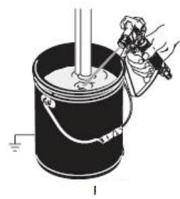
6. Переместите краскораспылитель в ведро с промывочной жидкостью, прижмите краскораспылитель к ведру, нажмите на спусковой механизм, чтобы тщательно промыть систему. Отпустите спусковой курок и включите предохранитель.
