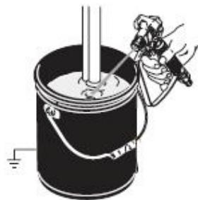
5. Прижмите краскораспылитель к заземленному металлическому ведру для промывки. Нажмите на спусковой механизм и промывайте краскораспылитель в течение 1 минуты.
